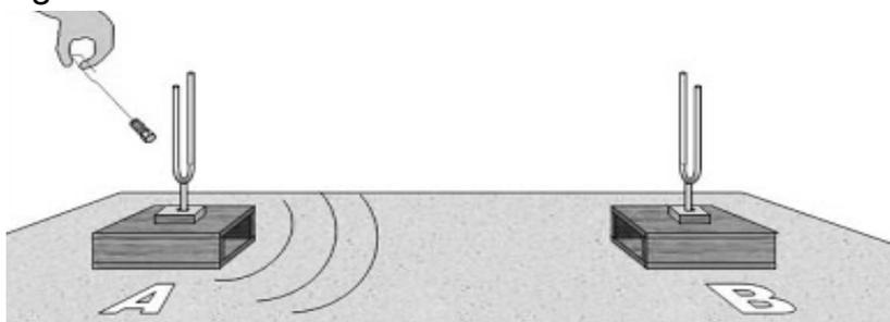
Este efecto se utiliza en múltiples áreas científicas y tecnológicas, ya que permite que un sistema amplifique su respuesta a una frecuencia particular sin la necesidad de una mayor intensidad de energía.
